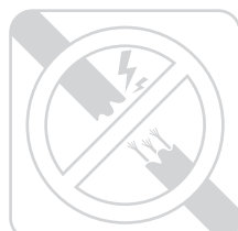
Skontrolujte, či nie sú poškodené vodiče
